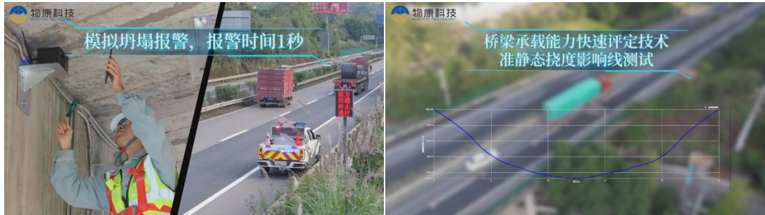
图 5 坍塌报警测试（左）、承载能力快速评定技术测试（右）
