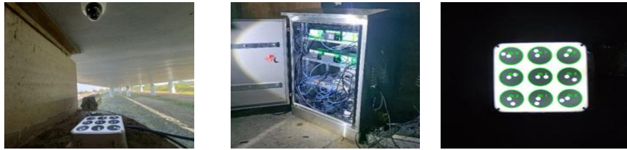
(a) 相机与阵列式靶标灯 (b) 边缘计算模块 (c) 图像识别
