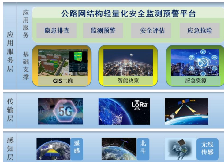
图 2 公路桥梁边坡群全覆盖、轻量化快速排查和监测预警技术框架
