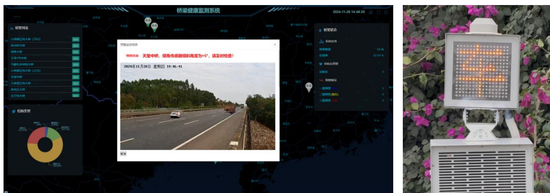
图 1 桥梁损毁系统平台报警并视频实时记录界面（经人工触发）
