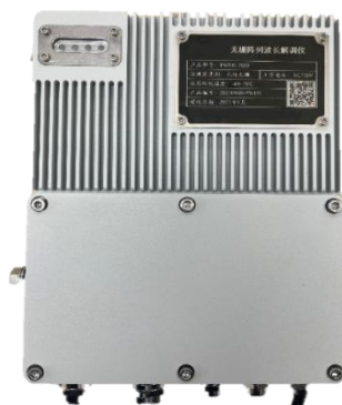
图 3 光栅阵列应变成像仪
