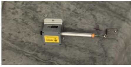
图 7 一体化裂缝计
